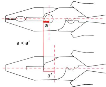
Comme la distance entre le rivet de liaison et l'arête de coupe (a) est nettement plus petite dans les pinces et les cutters dotés du système HIGH LEVERAGE que dans les pinces ordinaires (a'), il faut moins de force pour couper un fil de la même épaisseur.
