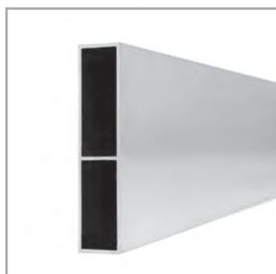
Section transversale d'un profilé de règle de maçon. Epaisseur du profilé 1,4 mm, poids du profilé 0,84 kg/m.
